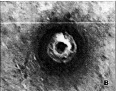
Рис. 3. Воздействие лазерного излучения диодного лазера 0.97 мкм мощностью 12 Вт: а) однократно продолжительностью 10 мс (контактно). б) однократно продолжительностью 500 мс, в) однократно продолжительностью 2000 мс
